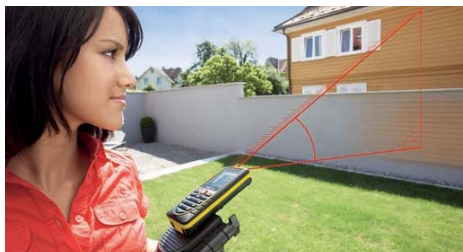
Edificación – Cálculo de la distancia horizontal por encima de obstáculos
